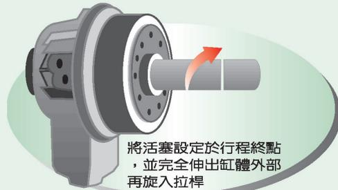
將活塞設定於行程終點，並完全伸出缸體外部再旋入拉桿
