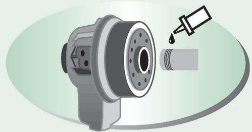
**油壓缸後面加裝集水盒時，應定期檢查清除鐵屑，保持切削液的暢通。**
